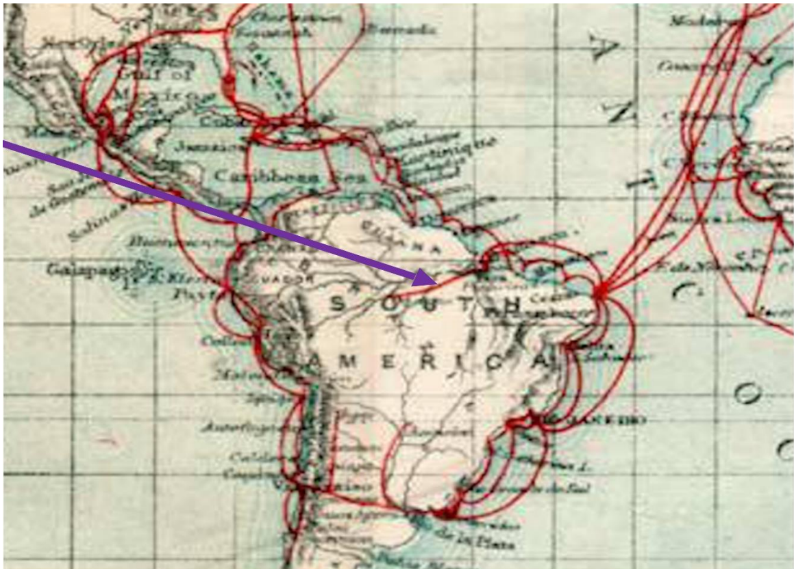
FIGURA 4 – Detalhe do cabo telegráfico fluvial ligando Manaus e Belém à Internet Vitoriana
